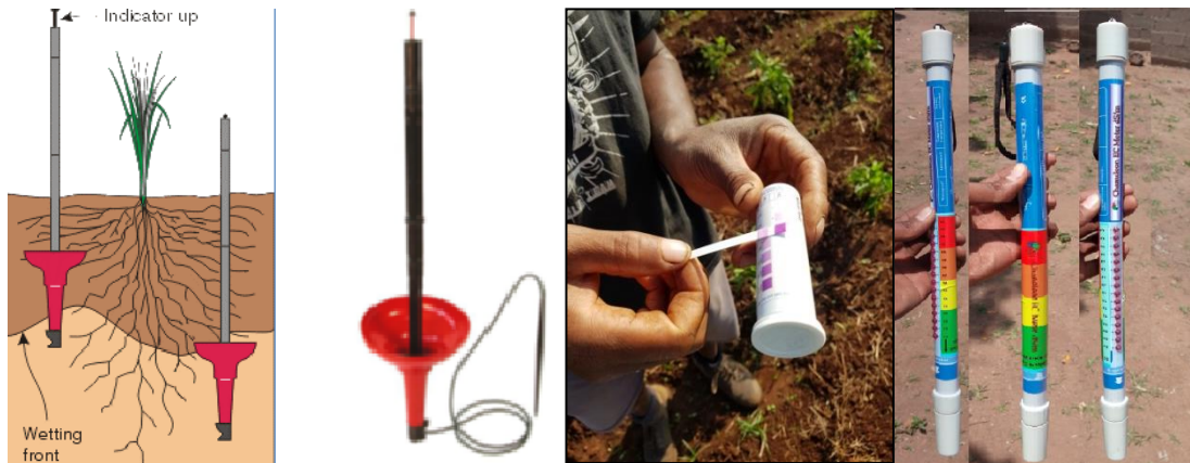
Figura 2: Equipamentos de monitoria de nutrientes (nitrogénio) e solutos (salinidade) no solo, disseminados nos regadios de pequena escala alvos de inervação no projecto TISA.
