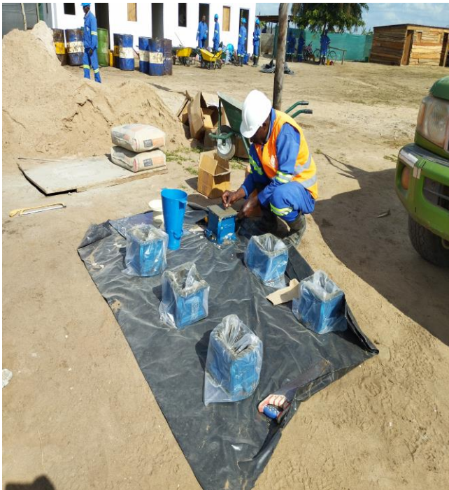
Foto 7: Extração de corpo de Prova para a testagem do betão
